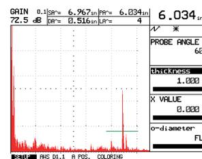
Поле в верхней части дисплея для четырехразрядного цифрового отображения тригонометрических расчетов при контроле сварных соединений. (SA — путь ультразвукового сигнала до дефекта в окне A, PA — проекционное расстояние до дефекта в окне A, DA — глубина до дефекта в окне A, LA — область контроля, обнаруживающая имеющийся дефект в окне A.)
