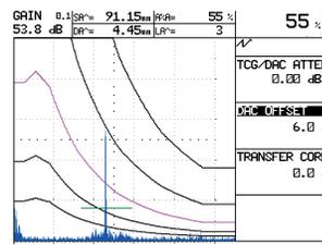
Инструменты для простого определения размеров дефектов. Отображено несколько кривых расстояние-амплитуда (DAC), сохраненная кривая DAC в пурпурном цвете, 4 дополнительные кривые получены при помощи функции dB Offset (смещение в дБ) для дополнительной помощи в определении размера дефекта. Возможности временной регулировки усиления (TCG) и корректировки параметров прохождения
